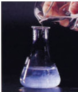
Мал. 38.3. Утворення осаду малорозчинного кальцій флуориду при зливанні розчинів натрій флуориду з кальцій хлоридом
