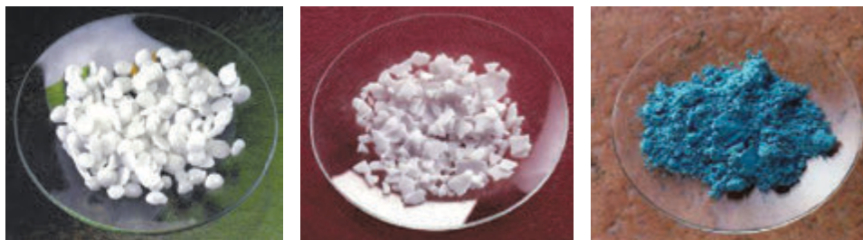
Мал. 32.1. Основи: а — натрій гідроксид являє собою білі гранули; б — калій гідроксид — білі лусочки; в — купрум(II) гідроксид — синій порошок
