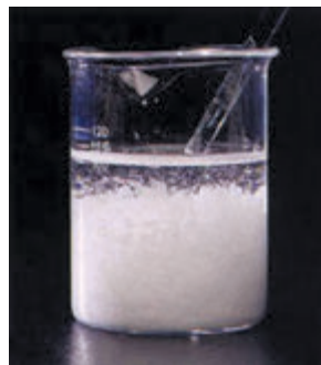
Мал. 38.2. Унаслідок зливання розчинів аргентум(I) нітрату та хлоридної кислоти утворюється осад аргентум хлориду
