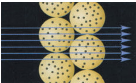
Мал. 9.2. Якби атоми фольги відповідали «кексовій» моделі, то альфа-частинки без опору проходили б крізь пластинку
