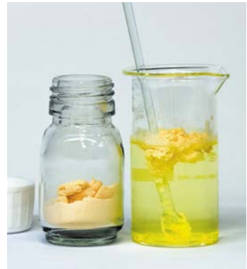
Мал. 20.3. Хоча густина сірки більша за воду, але вона не змочується водою, тому порошкоподібна сірка не тоне у воді
